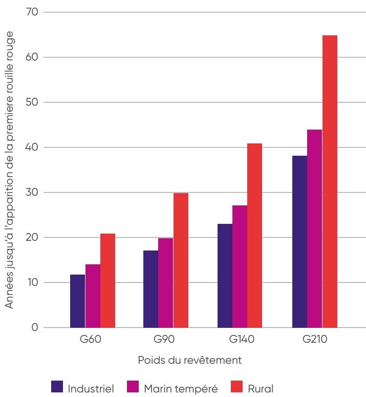
Le revêtement de zinc offre une protection galvanique sacrificielle des bords coupés pour empêcher la corrosion (rouille) sur les bords exposés. Pour ces applications, à mesure que l'épaisseur de l'acier augmente, un revêtement de galvanisation plus épais doit être utilisé pour assurer une protection galvanique suffisante des bords pour l'augmentation de la surface des bords coupés.
