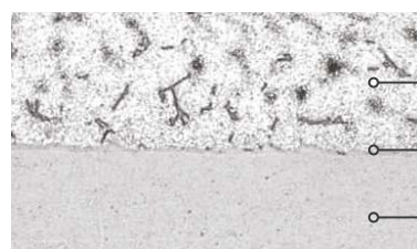
Coupe transversale métallographique de l'enduit Galvalume (500x)
