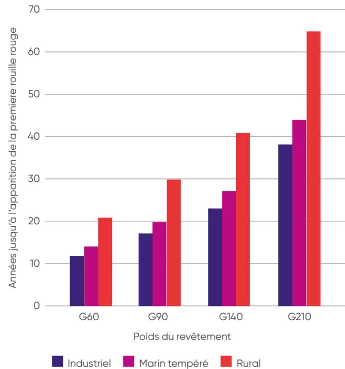
Le revêtement de zinc offre une protection galvanique sacrificielle des bords coupés pour empêcher la corrosion (rouille) sur les bords exposés. Pour ces applications, à mesure que l'épaisseur de l'acier augmente, un revêtement de galvanisation plus épais doit être utilisé pour assurer une protection galvanique suffisante des bords pour l'augmentation de la surface des bords coupés.
